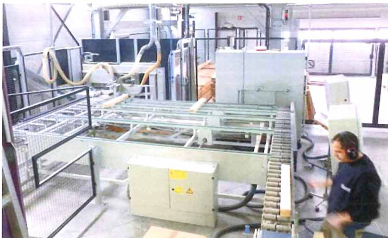
L'alimentation en carrelots (barres de 6 m ou prédébîts), se fait automatiquement en entrée de la nouvelle ligne Weinig, avec un système de palan innovant. Un seul responsable surveille toute la ligne.
