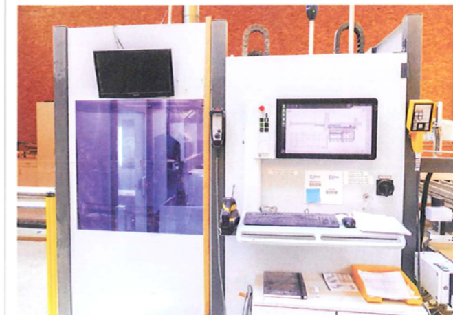
Das Einspielen der Aufträge erfolgt durch einen Scanner. Den Überblick über den Status der einzelnen Aufträge behält der Bediener über einen Monitor.
