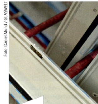
Das BAZ fräst eine Tasche in das Flügelprofil.
